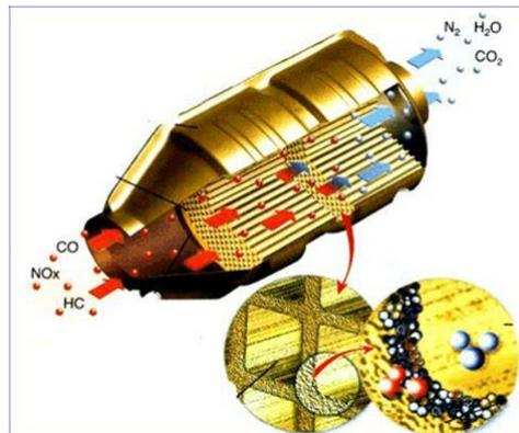
Figure 41 Représentation schématique d'un pot catalytique
