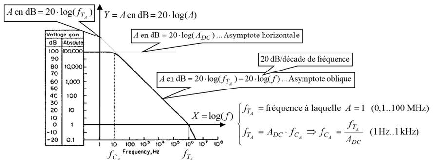
En conséquence, la fonction de transfert réelle d'un système bouclé, en contre-réaction, utilisant un ampli op, est donnée par :
