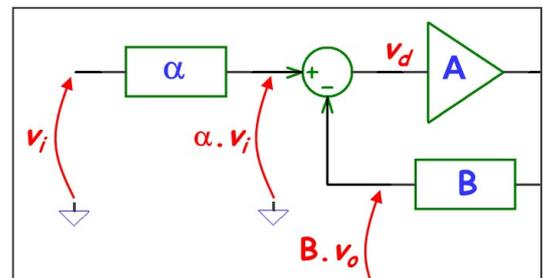
Par contre, si l'on tient compte d'un gain  $A$  <sup>[3]</sup> de valeur réelle la fonction de transfert du système devient :  $T_{A \neq \infty} = \frac{T_{\text{idéal}}}{1 + \frac{1}{A \cdot B}}$ . En DC (c.à.d. lorsque le système est soumis à des signaux continus), on a :
