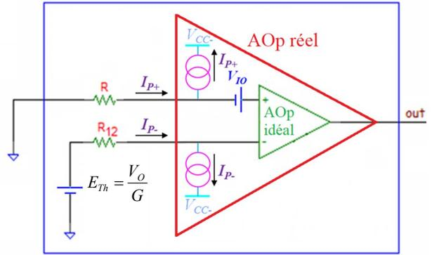
Notons que, alors que la résistance « vue » par le courant  $I_{P_+}$  est  $R$ , cette solution montre que la résistance « vue » par le courant  $I_{P_-}$  est  $R_1 // R_2$ . En traversant ces résistances, ces courants de polarisation engendrent des tensions en entrées de l'AOp, soit une tension différentielle, responsable de la composante de tension d'Offset  $(V_{Offset})_{I_P}$  en sortie de l'AOp :
