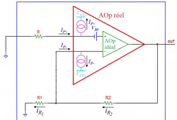
Etant donné que :  $v_d = \frac{v_o}{A} \ll V_{IO}$ , on peut à chaque fois admettre que  $v_d \approx 0 \Rightarrow v_- \approx v_+$  [4]
