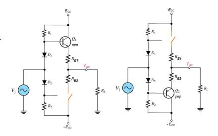
En conséquence, l'analyse de la puissance dissipée dans les transistors revient à traiter le cas de 2 circuits séparés, chacun alimenté par une source de tension  $E_{CC}$  et comprenant un transistor et une résistance  $R=R_E+R_L$ , l'un actif pendant l'alternance positive, l'autre pendant l'alternance négative, puisque chaque transistor conduit uniquement [1] pendant une alternance par période.
