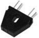
Ce composant est constitué d'une LED, généralement infrarouge et d'un photo-transistor, diode ou darlington. Les deux sont montés presque face à face, de manière à ce que le faisceau de la LED ne puisse arriver sur le phototransistor que s'il est réfléchi par une surface adéquate placée à une distance convenable.
