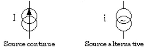
La définition est la même que pour la source de tension, sauf que la source de courant débite le **même courant quelle que soit la tension présente à ses bornes**.
