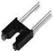
Ici le composant est constitué d'une LED et d'un photo transistor placé face à face en haut du composant. Ainsi à l'état naturel le faisceau est intact et le phototransistor est passant. Si un objet (feuille, plaque fine) le coupe, le transistor ne passe plus.
